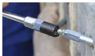
DESOL Snappy auf den Kegelnippel schieben, Sicherungssteg unten | Push the DESOL Snappy onto the round head nipple (locking bar at the bottom)
