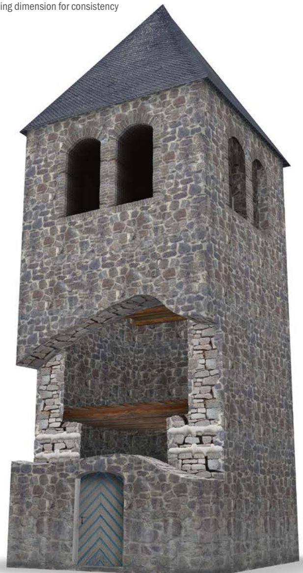
Verbindung abgelöster Mauerwerkschalen Connection of separated wythes
