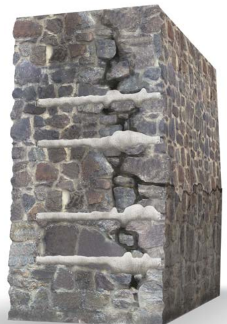
Anbindung abgelöster Mauerwerkschalen Connection of separated wythes
