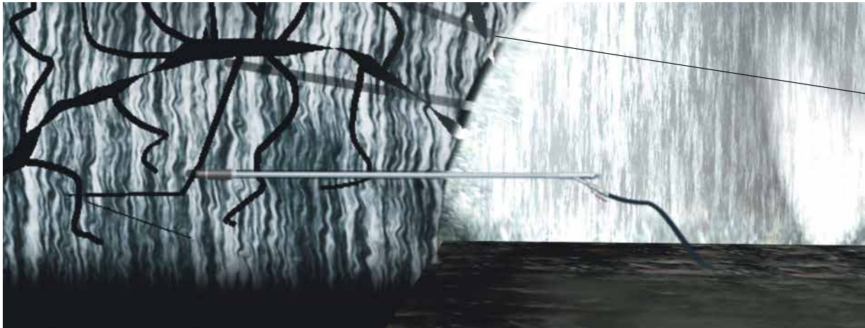
Spannpacker positionieren und mit der Spann- und Injektionsvorrichtung verspannen Place clamping packer and fix it using the clamping and injection device
