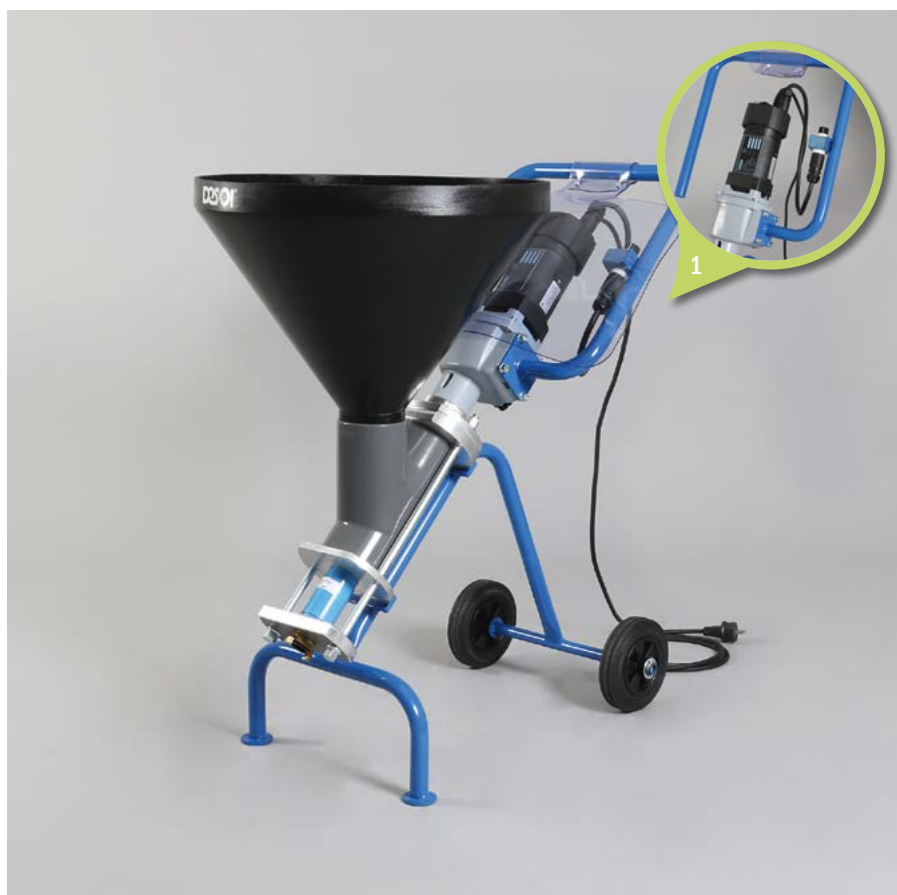
1. Stufenlose Fördermengenregulierung | Infinitely variable delivery rate regulation
