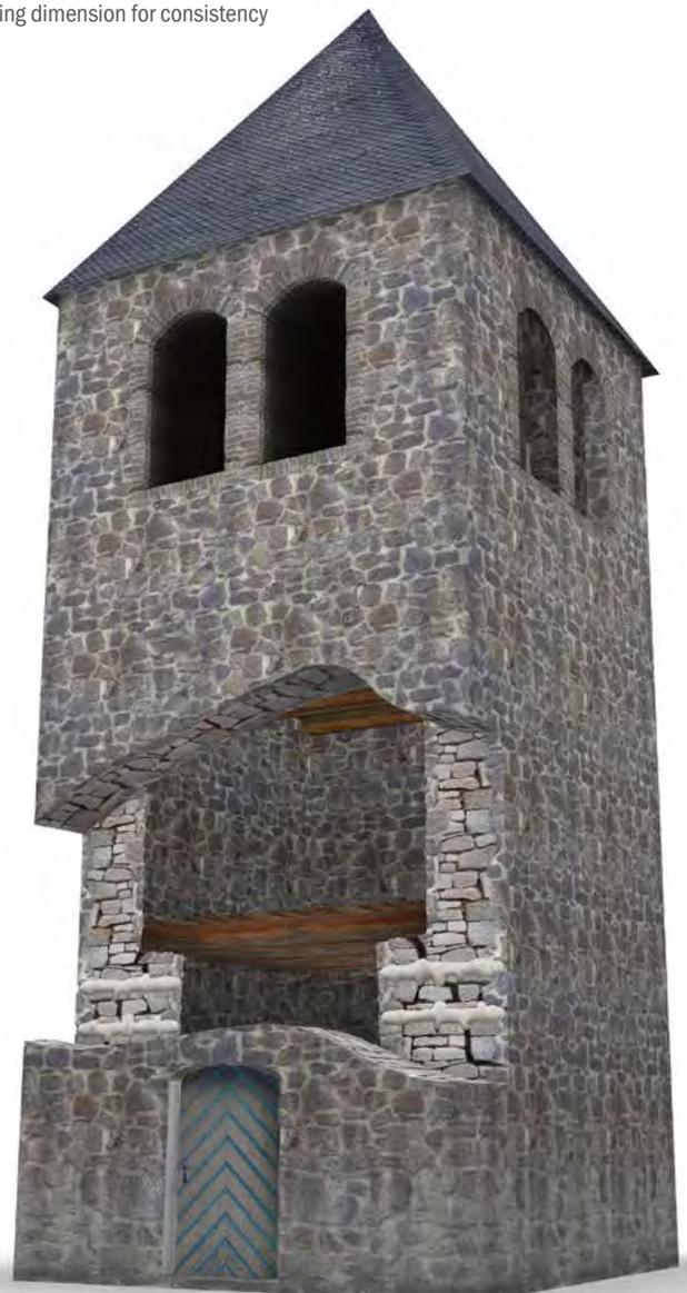
Verbindung abgelöster Mauerwerkschalen
