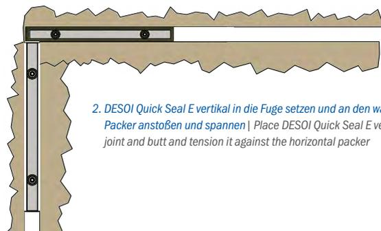
2. DESOI Quick Seal E vertikal in die Fuge setzen und an den waagrechten Packer anstoßen und spannen | Place DESOI Quick Seal E vertically in the joint and butt and tension it against the horizontal packer
