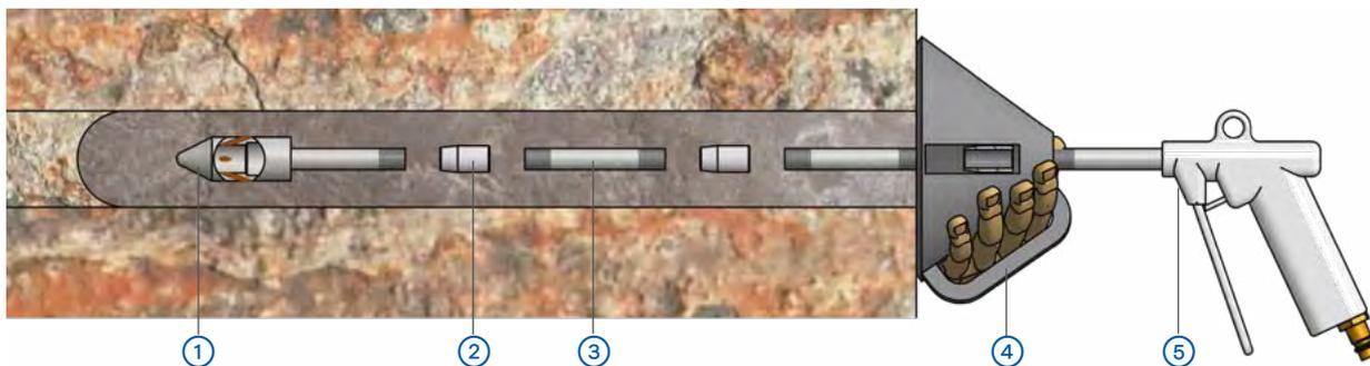
Die Ausblaslanze aus Aluminium wird eingesetzt, um Bohrlöcher ab einem Durchmesser von 20 mm gründlich von Restteilen, wie z. B. Bohrgut, Bruchstücke, Staub etc. zu befreien.
