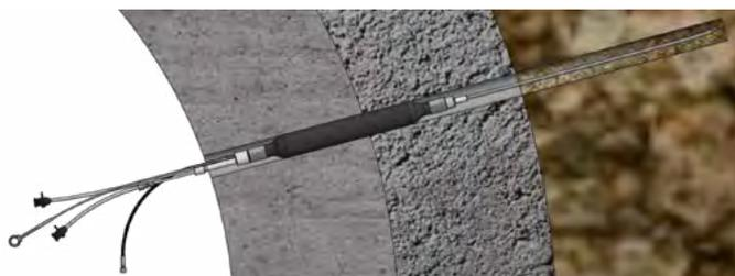
Gespannter Blähpacker mit Entlüftung vor der Injektion
