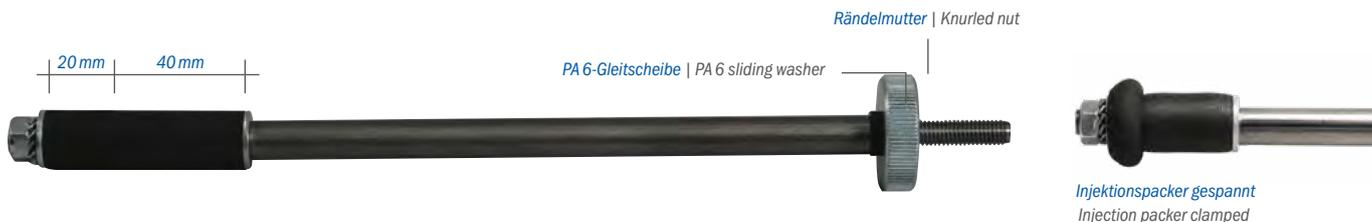
Spanngummi 60 mm, Außengewinde M8, freier Durchgang Ø 3 mm, PA 6 Gleitscheiben, Rändelmutter | clamping rubber 60 mm, external thread M8, free passage Ø 3 mm, PA 6 sliding washers, knurled nut
