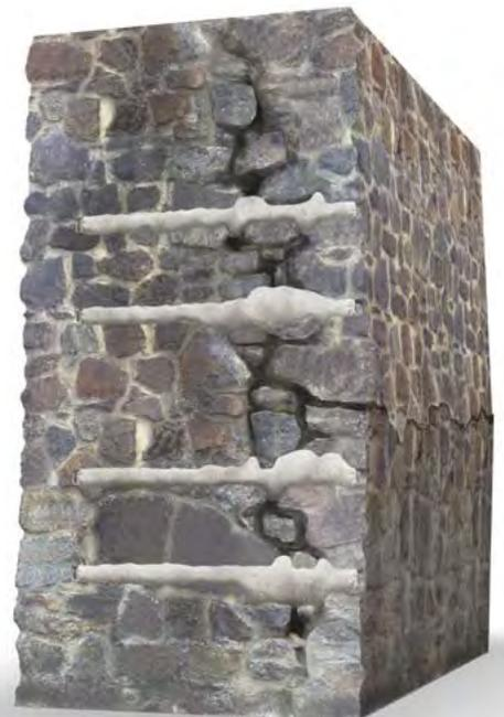
Anbindung abgelöster Mauerwerkschalen
