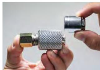
Schiebekupplung auf den Flachkopfnippel aufschieben
