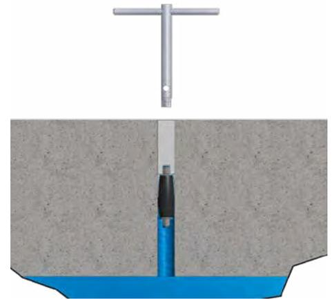
Verschließen des Bohrlochs mit Blindpacker
