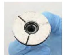
*Fertige Klebefläche, Zugang zum Riss bleibt erhalten*
