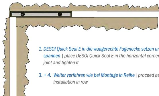
1. DESOI Quick Seal E in die waagerechte Fugenecke setzen und spannen | place DESOI Quick Seal E in the horizontal corner of the joint and tighten it
