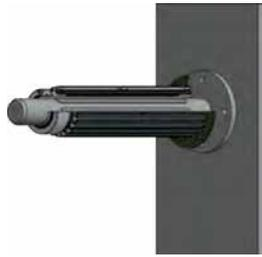
2. Das Aufschieben der Wickelhülse bis etwa 40 mm vor dem Anschlag
