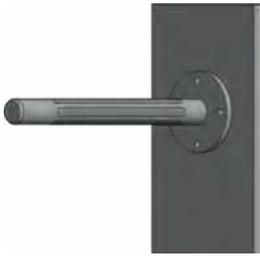
1. Der pneumatisch-mechanische Wickeldorn in der jeweiligen Produktionsmaschine
