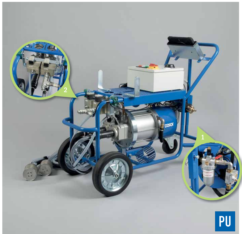
1. Druckminderer mit Manometer und Frostschutzeinrichtung | Pressure regulator with manometer and anti-freeze device 2. Durchflusssensoren | Flow sensor
