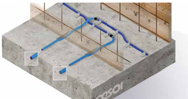
① Befüll- und Entlüftungssystem mit Injektionsschlauch ① Filling and venting system with injection hose
