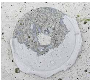
Sehr gute Adhesion auch zwischen Kleber und Packer Très bonne adhésion aussi entre l'adhésif et l'injecteur
